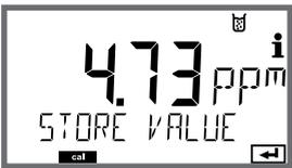
L'écran affiche '4.73 ppm' en grand, 'STORE VALUE' en dessous, et une barre d'état 'cal' clignotante en bas à gauche. Un petit 'i' est visible à droite. | Prélèvement d'échantillon et mise en mémoire de la valeur.<br>Continuer avec <b>enter</b> | L'échantillon peut alors être mesuré en laboratoire.                                                                                     |
