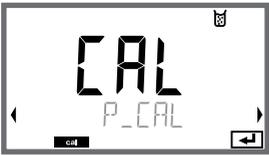
L'écran affiche 'CAL' en grand, 'P_CAL' en dessous, et une barre d'état 'cal' clignotante en bas à gauche. Des flèches de navigation sont visibles.       | Sélectionner le calibrage du produit : P_CAL<br>Continuer avec <b>enter</b>               | Si un code d'accès a été défini pour le calibrage dans le menu Service, et en cas de saisie erronée, l'appareil retourne au mode Mesure. |
