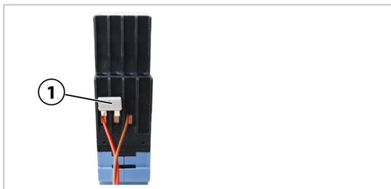
10. Raccorder les câbles pour l'entrée. Monter le cavalier à insérer **(1)** en fonction de la plage d'entrée souhaitée (voir exemple : Cavalier placé sur les bornes 5 et 6).
