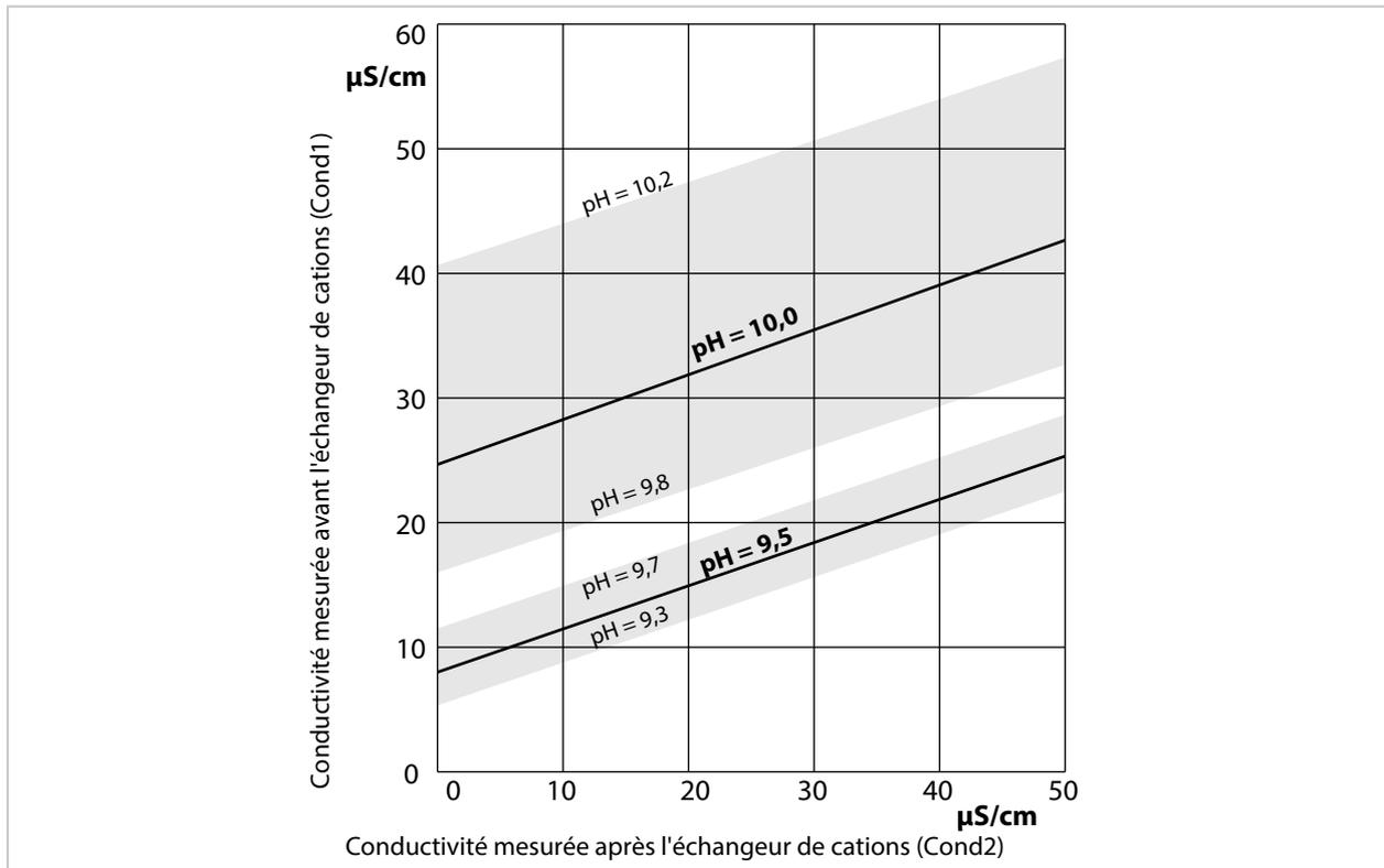
Conditionnement de l'eau de chaudière des chaudières à circulation naturelle avec de l'hydroxyde de sodium. Relation entre la valeur du pH et la conductivité mesurée en amont ou en aval de l'échangeur de cations.
