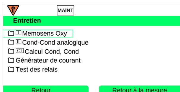
Le menu Entretien propose différentes fonctions permettant de contrôler le fonctionnement de l'appareil :
