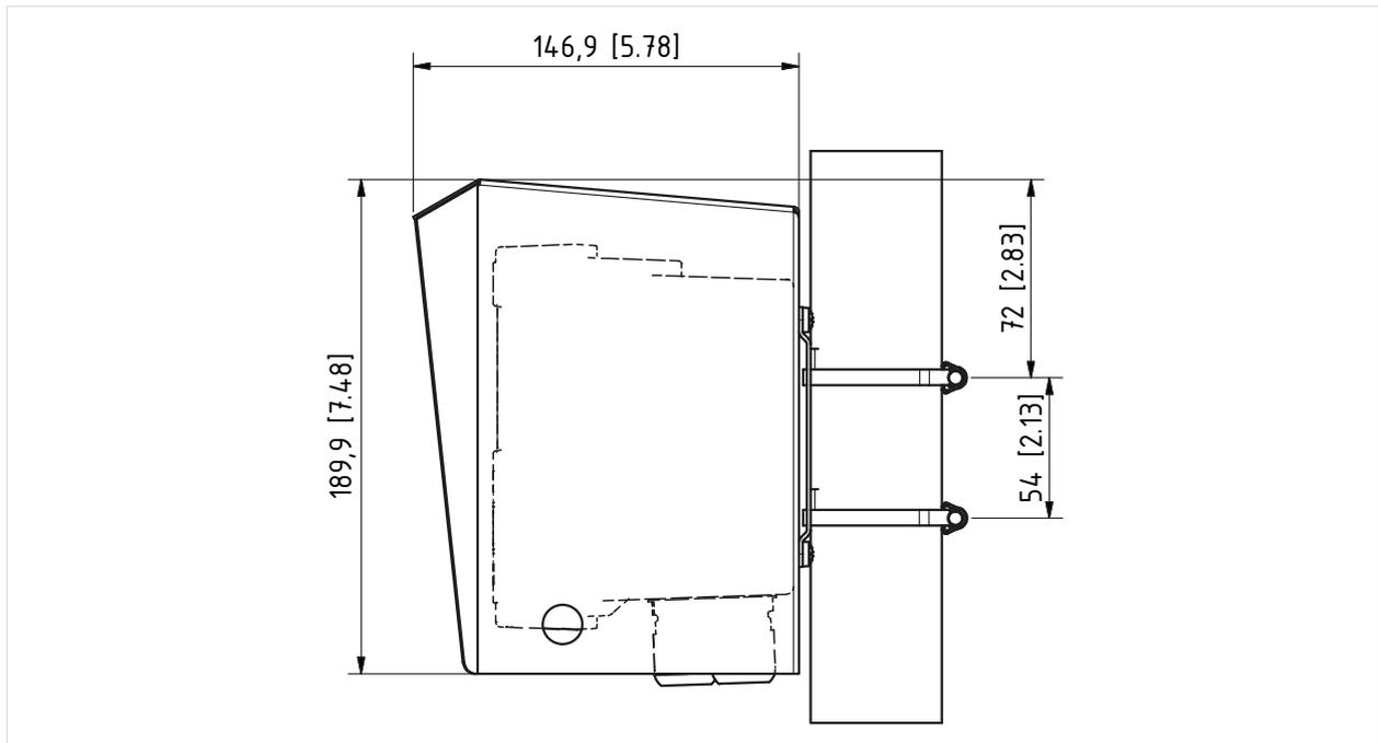
L'auvent de protection ne peut être utilisé qu'en cas de montage mural ou sur mât.
