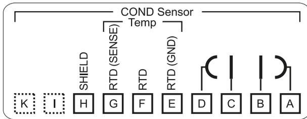
**Module de mesure de conductivité par induction**
