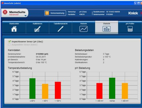
Historique : Diagrammes de charge des électrodes
