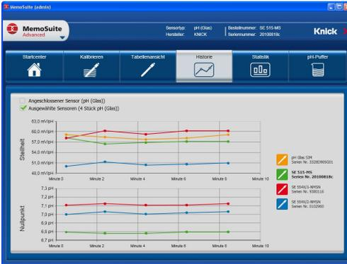
Calibrage pour plusieurs électrodes
