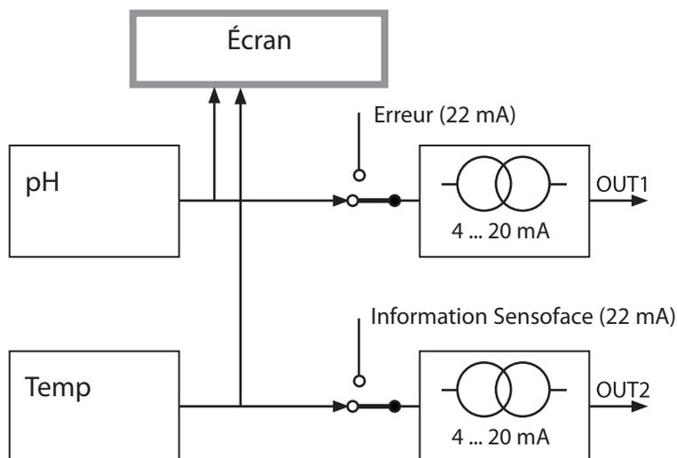
Les informations d'erreur et les informations Sensoface peuvent être traitées séparément pour les deux sorties de courant. Il est ainsi possible d'émettre uniquement des messages d'erreur sur la sortie de courant 1 et uniquement des informations Sensoface sur la sortie de courant 2.
