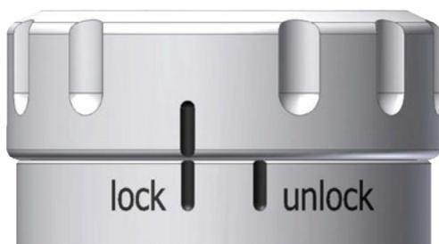
La rotation de l'anneau SensoLock® en position « lock » empêche la sonde de pénétrer dans le process lorsque l'électrode est démontée (blocage de la fonction de déplacement, fonction de sécurité).
