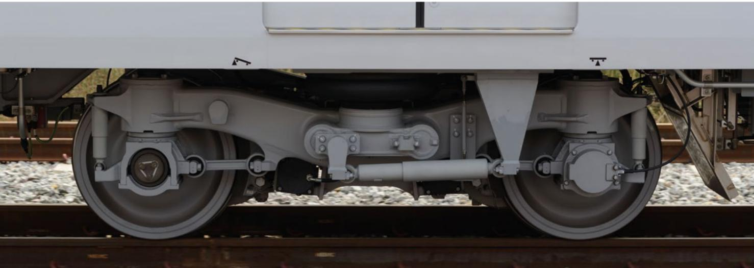
철도용 차량 안팎의 다양한 시스템은 현재 속도에 대한 정보를 필요로 합니다. 여기에는 기능안전에 중요한 두 시스템인 브레이크 시스템과 드라이브 기술이 포함됩니다. 따라서 속도 데이터를 전달하는 인코더와 센서는 안정적이고 정밀하게 작동해야 합니다.
