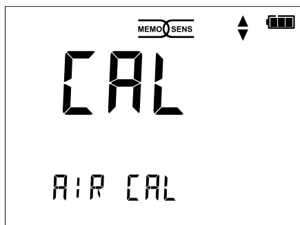
Calibrage – étape 1 (Méthode de calibrage : dans l'air)
