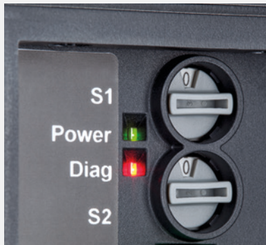
La LED indique l'état du contact de diagnostic
