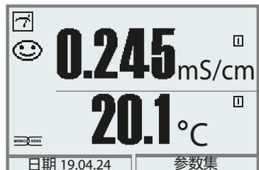
使用 Protos 3400(X) 时：在 Memosens 传感器连入期间，显示屏上显示 Memosens 符号。
