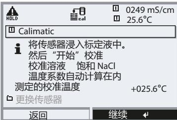
自动检测校准温度时，Protos 通过 Memosens 传感器内置的温度探头来测量校准溶液的温度。
