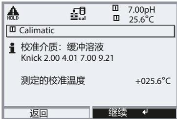
Protos 利用 Memosens 传感器内置的温度探头测量缓冲溶液的温度。
