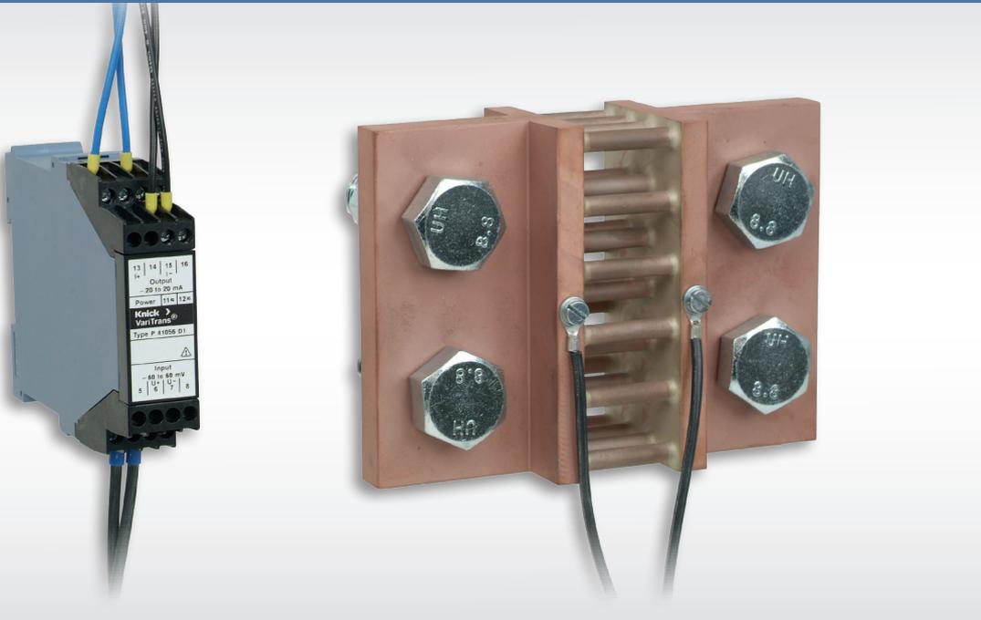
60 mV의 낮은 분로 전압은 분로 저항기의 크기를 비교적 작게 만듭니다. 낮은 분로(선트) 전압은 측정 정확도를 저하시키지 않습니다. 이는 크닉의 분로(선트) 절연 증폭기가 바로 이런 용도에 특히 최적화되어 있기 때문입니다. 또한 kV 범위까지 연결되는 높은 시스템 전류 역시 확실하게 감지할 수 있습니다. 3포트 절연 트랜스미터는 최대 3.6 kV의 작동 전압, 15 kV의 시험 전압까지 높은 수준의 갈바닉 절연을 적절히 제공하도록 설계되었습니다.
