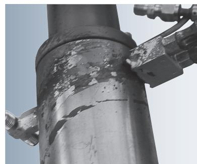
传统的伸缩式连接件: 杂乱的软管 (左侧) 和未受保护的限位机构上的沉积物 (右侧)
