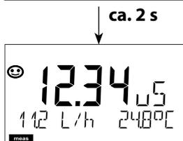
Kurzes Drücken von **meas** ruft weitere Displaydarstellungen auf, zum Beispiel Messstellenbezeichnung (TAG) oder Durchfluss (l/h). Diese sind türkis hinterleuchtet und wechseln nach 60 s zum Hauptdisplay.
