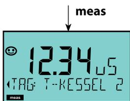
Kurzes Drücken von **meas** ruft weitere Displaydarstellungen auf, zum Beispiel Messstellenbezeichnung (TAG) oder Durchfluss (l/h).
