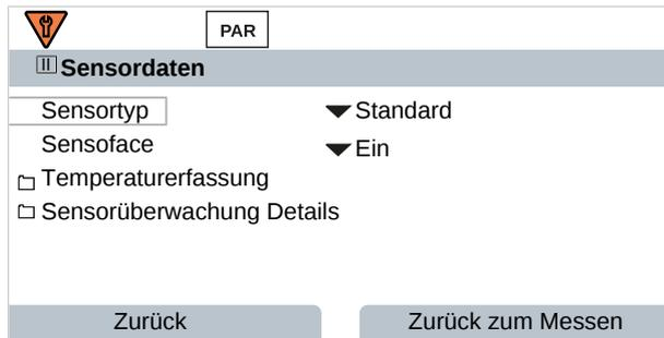
01. Unter **Temperaturerfassung** wählen Sie den verwendeten Temperaturfühler und ob die Temperatur während des Messens und/oder Kalibrierens automatisch oder manuell gemessen werden soll.
