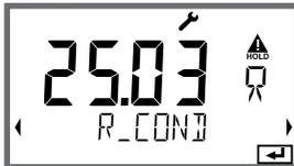
Capacidad residual del intercambiador de iones
