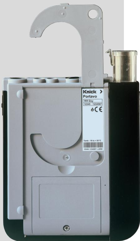
Mit dem integrierten Datenlogger können bis zu 5.000 Werte aufgezeichnet werden. Über die USB-Schnittstelle und mit der Software Paraly SW 112 können die Loggerdaten komfortabel zum PC übertragen und dort ausgewertet werden.
