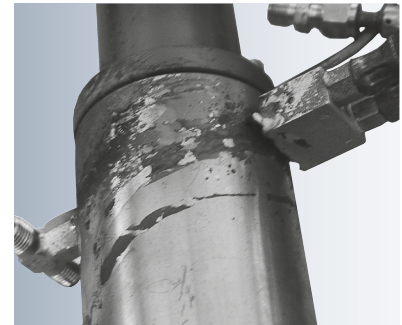
Herkömmliche Wechselarmaturen: Schlauchwirrarr (links) und Ablagerungen an ungeschützter Endlagenmechanik (rechts)
