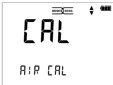
Calibrage oxygène – étape 1 (Calibrage à l'air)
