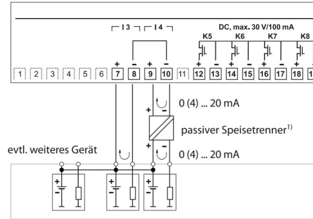
**ACHTUNG!** Bei Verwendung von nur einem Speisetrenner und weiteren angeschlossenen Geräten darauf achten, dass eine korrekte Potentialtrennung gewährleistet ist.
